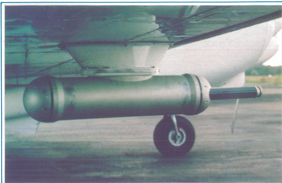
*Sous une aile de l'avion, un Knollenberg du nom de son inventeur. Celui-ci de type FSSP 100 est un spectromètre à laser qui permet de connaître la répartition des fines gouttelettes nuageuses dans la gamme 0.5 à 40  $\mu\text{m}$ .*
