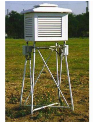
Abri météorologique réduit (Contient les thermomètres mesurant la température minimale et maximale)
