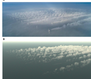
Photographie (A) et simulation couplée avec les éoliennes (B, \Delta x=5m ) des nuages générés par le parc offshore de Horns Rev 1 (Joulin et al., 2020, Frontiers)
