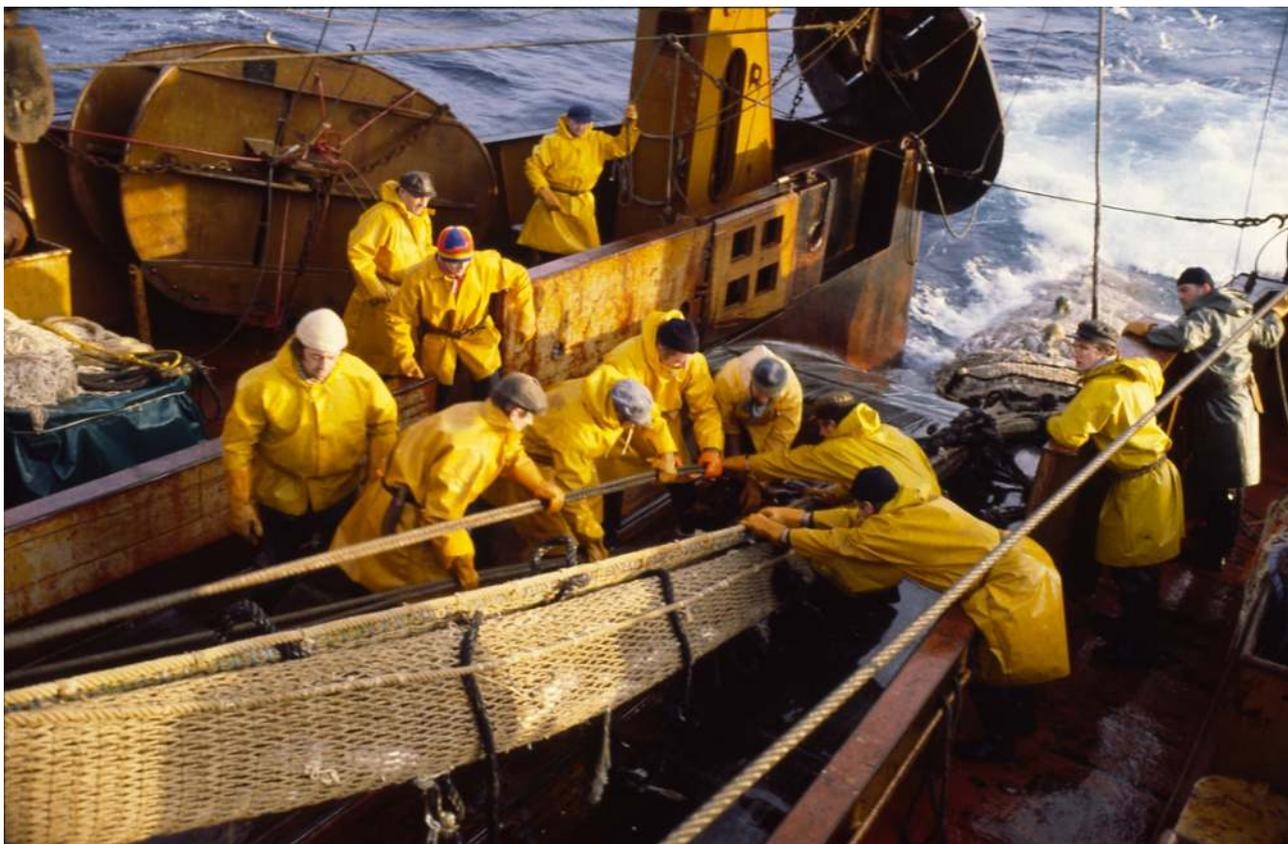
Enfin, le cul du chalut est hissé, une trappe s'ouvre au milieu du pont, un marin largue le nœud qui ferme le cul du chalut et le poisson tombe directement à l'étage au-dessous.
