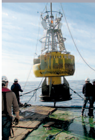
Mouillage d'une bouée Marisonde dans le Golfe du Lion
