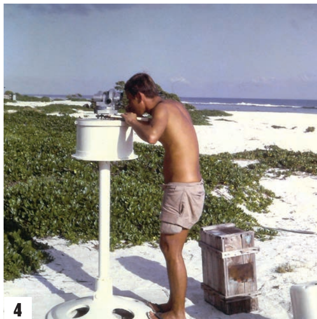
4 : suivi de ballon au théodolite 5 : antenne du radar Rawin 6 : lâché de ballonsonde aux Gambier
