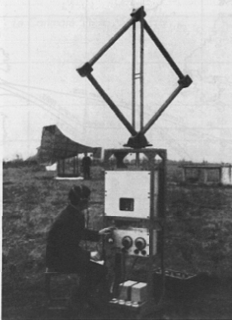
Essai de radiogoniomètre à Trappes en 1936. Cet appareil constitue un développement de celui figurant sur la page 62. On reconnaît dans le fond un pavillon récepteur du système de sondage acoustique. Photo Météo-France.
