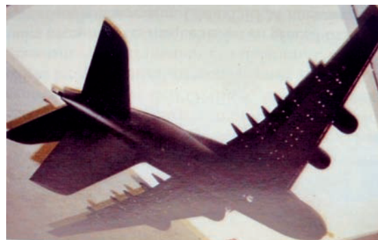
Maquette d'un Airbus A340 de 2,25 m d'envergure en cours de catapultage. Il s'agit de procéder sur cette pièce à des études de mécanique de vol en présence de rafales de vent verticales ou horizontales.
