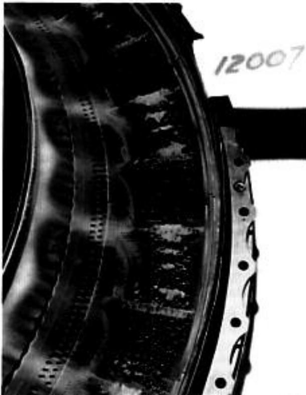
Réacteur du Boeing 747 après son passage dans le panache du Redoubt. On note bien les dépôts de cendre refondue et l'oxydation extrême des parties métalliques.
