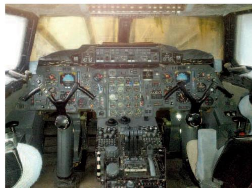
Photo 4 : poste de pilotage du Concorde
