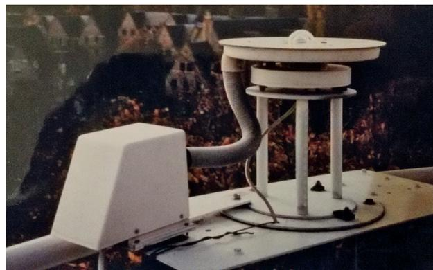
Photo 10 : pyranomètre
