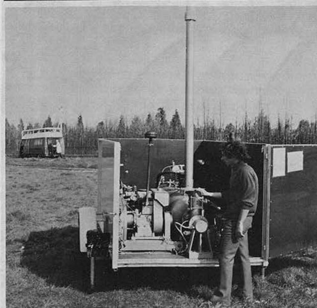
La sarbasonde : sondage vertical par sonde-flèche
