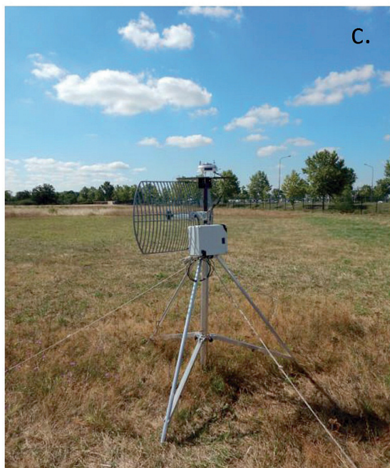
Figure 1 : Caméra all-sky avec système d'orientation et d'alignement (a), image all-sky (b), installation des caméras sur un mât avec antenne wi-fi (c), et orientation des caméras (d).
